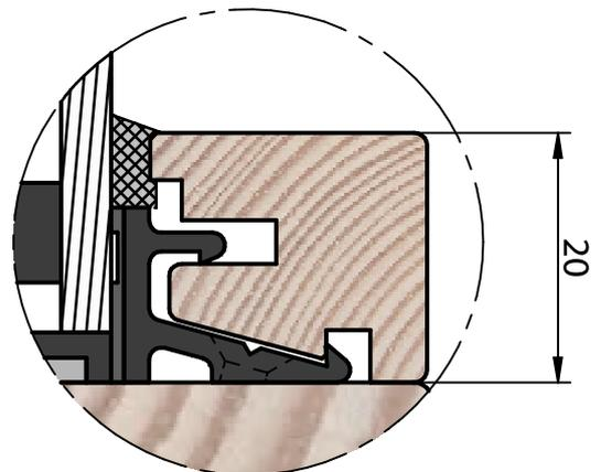
$\text{Glasleistenbreite} = \text{Falztiefe} - X - \text{Glasdicke} - 4 \text{ mm für Keildichtung}$
