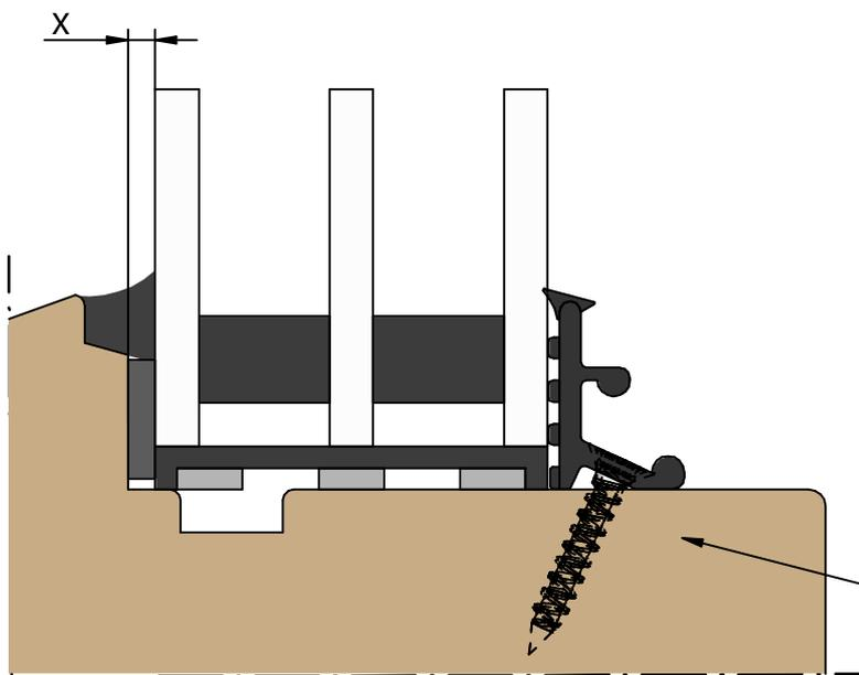
3. FIXclip-Schienen locker an Scheibe anlegen und die Schrauben im leichten Winkel, entsprechend den Bohrungen eindrehen.
